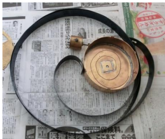
写真24 はらつく工房の復元モデルの香箱とゼンマイ
